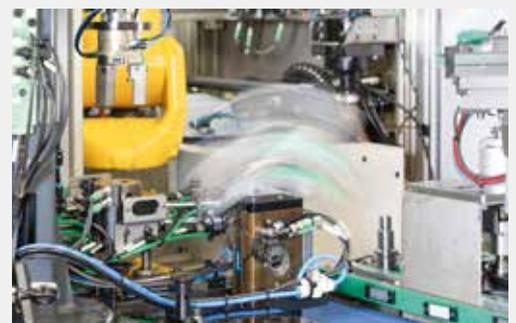
Die SRM 25 wendet das Bauteil und setzt es anschließend auf dem Abführband ab.
