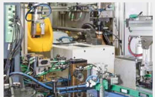
Nach der Bearbeitung in der Rändelmaschine übergibt der Roboter das Bauteil über den Zentrischgreifer PZN-plus 64 an eine kundenspezifische Werkstückaufnahme an der SRM 25. Um verschiedene Werkstückvarianten greifen zu können, ist der PZN-plus mit einem Backenschnellwechselsystem BSWS-UR ausgestattet.
